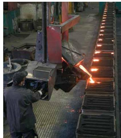
Wir sind auf hochwertigen Sphäroguss / Duktulguss GJS (GGG) und Gusseisen mit Kugelgraphit spezialisiert. Mittels Spektralanalyse wird die Zusammensetzung ständig kontrolliert. Neben den eigenen Produkten für die Trinkwasserversorgung wird in unserer Gießerei auch für den Bereich Maschinen- und Anlagebau gegossen. Gießen ist der kürzeste Weg vom flüssigen Werkstoff zum Fertigprodukt bei größter Freizügigkeit in der Bauteilgestaltung.
